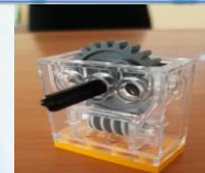
Сборка червячной передачи
